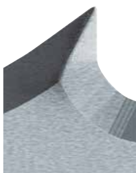
Dente amaciado corretamente Diente ablandado correctamente
