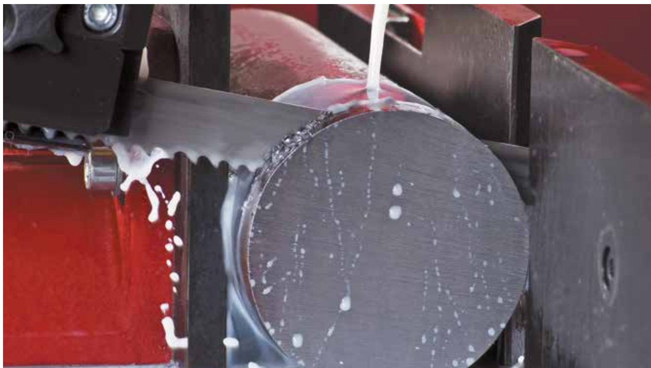
Após o amaciamento (20 a 30 minutos), aumente o avanço gradualmente até alcançar o avanço de corte recomendado Después del ablandamiento (20 a 30 minutos), aumente el avance gradualmente hasta alcanzar el avance de corte recomendado
