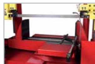
Morsa com grande capacidade e haste para cortes segmentados Mordaza con gran capacidad y hasta para cortes segmentados
