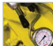
Tensionamento hidráulico da lâmina Tensado hidráulico de la lámina
