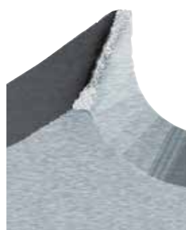
Dente sem amaciamento Diente sin ablandamiento
